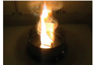
L'auto-échauffement provoque l'inflammation spontanée
