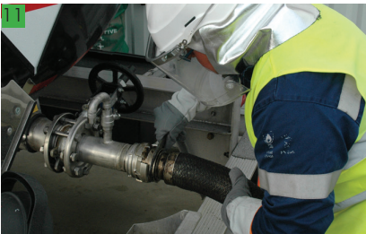
Fixer le flexible côté citerne et serrer le raccord
