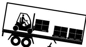
Rupture de la béquille
