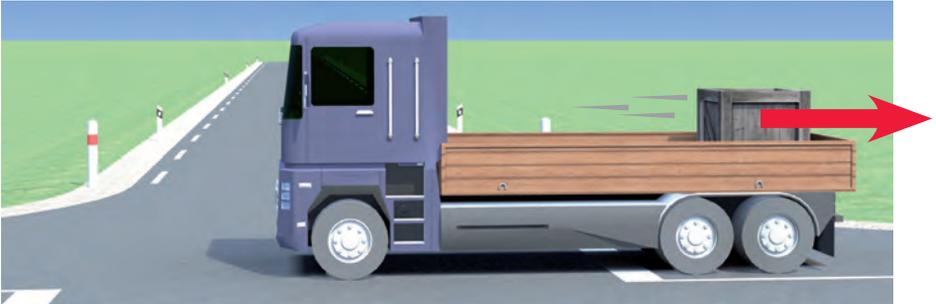
**Au cours de l'accélération, la force d'inertie tire la charge vers l'arrière**
